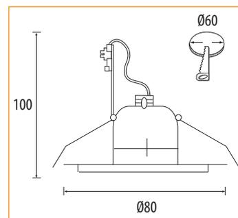
Corps métallique. Bornier de raccordement.
